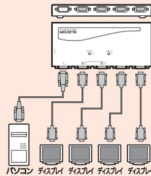
長距離伝送表示可能(最大65m) アナログRGB信号中断時の省エネモード対応 高解像度(1920×1440dpi)対応
