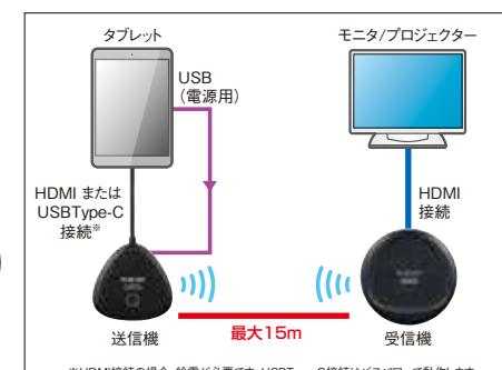
※HDMI接続の場合、給電が必要です。USBType-C接続はバッテリーで動作します。
