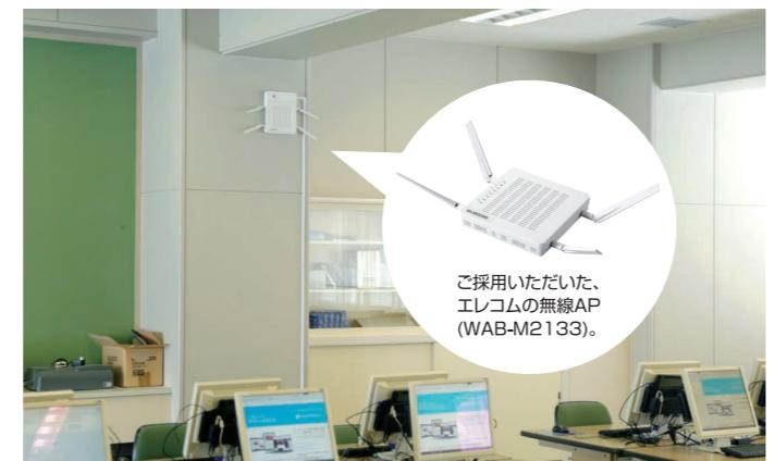
今回、導入となったWAB-M2133は、5GHz帯と2.4GHz帯の同時利用に対応しており、同時接続が最大250台(推奨接続台数125台)と多いのが特徴である。また、平等通信機能は、多数の端末が接続した時に動画再生やデータダウンロードにおける通信処理の待ち時間を軽減できる機能である。
