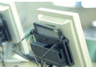
タブレット端末は液晶モニター背面のポケットに収納されおり、端子類を抜くと持ち出すことができる。
