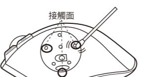
清潔光學式感應器附近時, 請勿損傷感應器。
