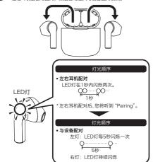
左右耳机配对后,将进入与设备的配对模式。I FD灯的闪烁模式会发生变化。
