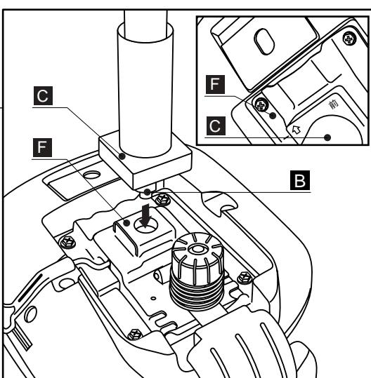
行程1で組み上げた脚部のガスシリンダー **B**先端を座受けプレート **F**の図の位置に差し込みます。
