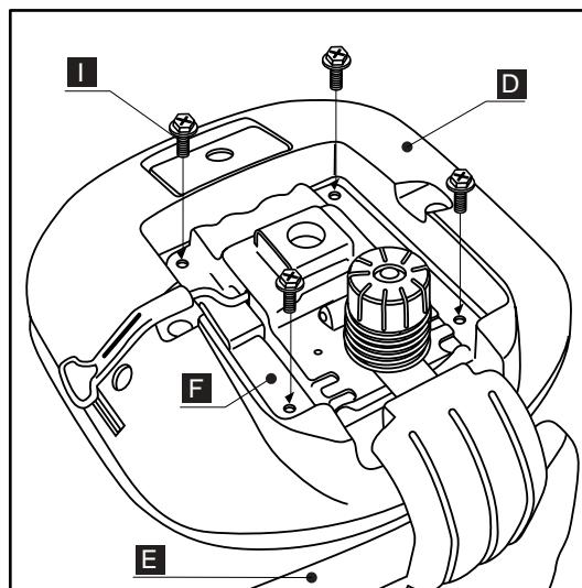
座シートに取り付けているネジ **I**を外し、座受けプレート **F**を図のように置き、先程外したネジ **I**で取り付けます。
