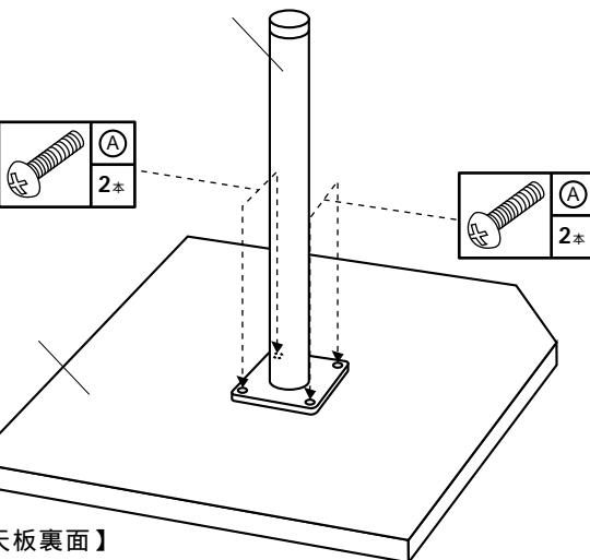
3 前項2でデスクに取り付けた連結金具に、コーナーテーブル本体をボルト A で取り付け(仮締め)ます。
