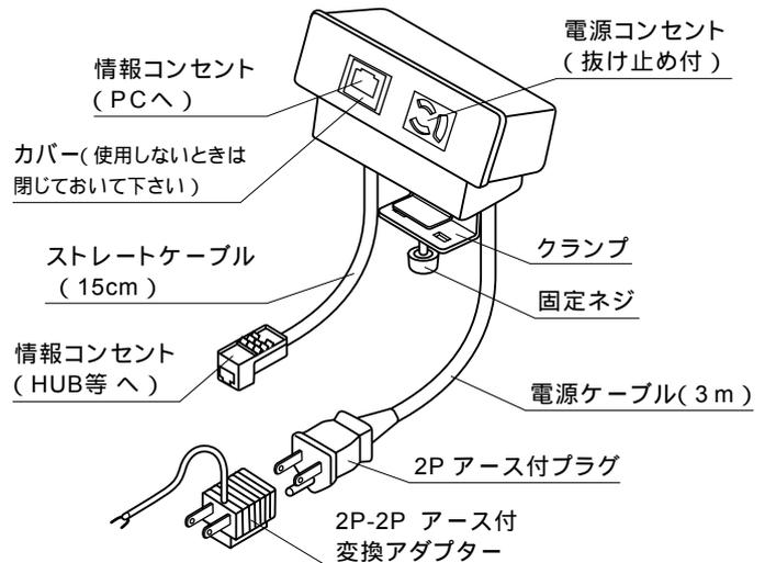
使用環境・電力機器の影響によってはデータ転送速度が低下する場合があります。特にEATA-02の使用時にデータエラー等の不具合が発生した場合、電源と情報の同時使用を中止して下さい。
