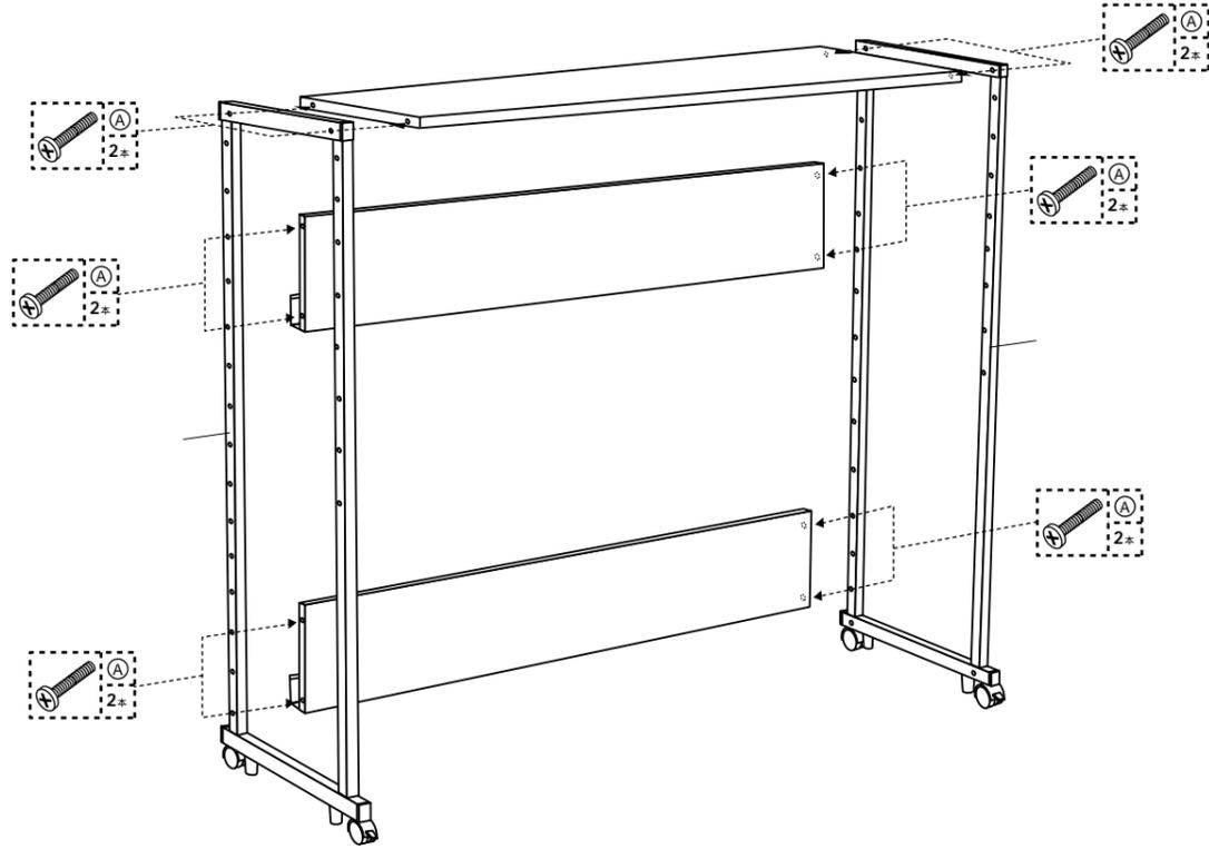
**2** フレーム に棚、キーボードテーブル をボルト A で図のように取り付け(固定)ます。
