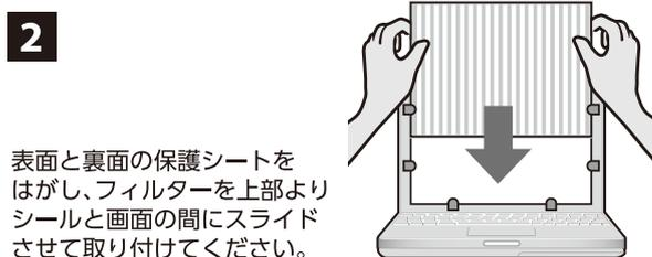
表面と裏面の保護シートをはがし、フィルターを上部よりシールと画面の間にスライドさせて取り付けてください。
