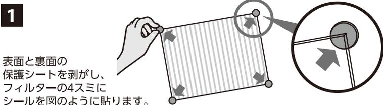
表面と裏面の保護シートを剥がし、フィルターの4スミにシールを図のように貼ります。
