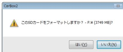
フォーマットが開始されます。終了すると、SDHC カードをセットし直すようメッセージが表示されます。
