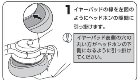
**1** イヤーパッドの縁を左図のようにヘッドホンの隙間に引っ掛けます。
