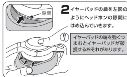
**2** イヤーパッドの縁を左図のようにヘッドホンの隙間にはめ込んでいきます。
