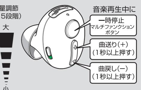
●LEDランプが消灯から青で3回点滅して電源がオンになり、自動的に機器との接続が完了すると、LEDランプは青で7秒ごとに2回点滅します。
