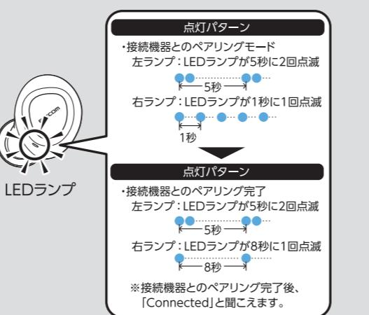
ヘッドホン同士のペアリング完了後、接続機器とのペアリングモードとなり、LEDランプの点滅が切り替わります。
