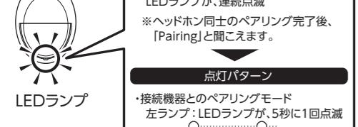
ヘッドホン同士のペアリング完了後、接続機器とのペアリングモードになり、LEDランプの点滅が切り替わります。
