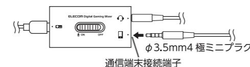
**スマートフォンまたはパソコンに接続する前にφ3.5mm4極ミニプラグケーブルをデジタルミキサーに接続した場合、その状態でもう片方のプラグの端子部分を手で触るとヘッドセットから人体を原因とする大きなノイズが聞こえます。**
