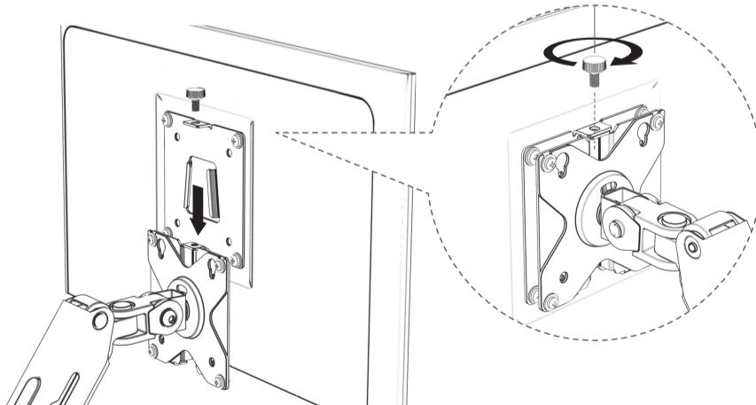
モニター用ブラケットの穴とモニターの穴を合わせてネジを通して、プラスドライバーでしっかりと締めこんでください。
