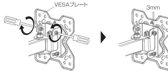
2 壁掛け金具本体のアーム部分先端下部のネジを外して、壁掛け金具本体からVESAプレートを取り外します。
