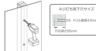
4 下穴と壁掛け金具の穴の位置を合わせて、壁掛け金具の穴とワッシャーにST6.3x55ネジを通して、10mm六角スパナかプラスドライバーでしっかりと固定してください。
