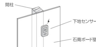
2 間柱の位置がわかったら、壁掛け金具を間柱の位置に合わせ、水準器で水平であることを確認して、穴にマーキングしてください。
