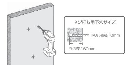
3 下穴に樹脂アンカーを挿入し、下穴と壁掛け金具の穴の位置を合わせて、壁掛け金具の穴とワッシャーにST6.3x55ネジを通して、10mm六角スパナかプラスドライバーでしっかりと固定してください。
