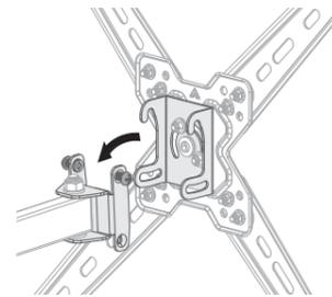
2 壁掛け金具アーム先端上部と下部のネジを締めて固定します。
