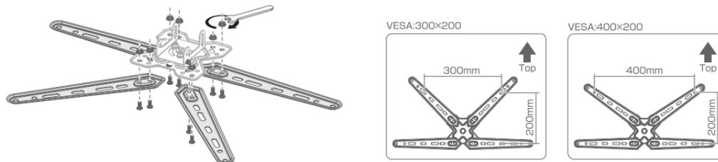
2 拡張プレートの穴とテレビの穴を合わせて、プラスドライバーでネジをしっかりと締めてください。
