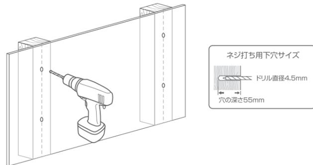
4 下穴と壁掛け金具の穴の位置を合わせて、壁掛け金具の穴とワッシャーにST6.3×55ネジを通して、10mm六角スパンカプラスドライバーでしっかりと固定してください。
