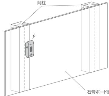
2 間柱の位置がわかったら、壁掛け金具を間柱の位置に合わせて、水準器で水平であることを確認して、穴にマーキングしてください。
