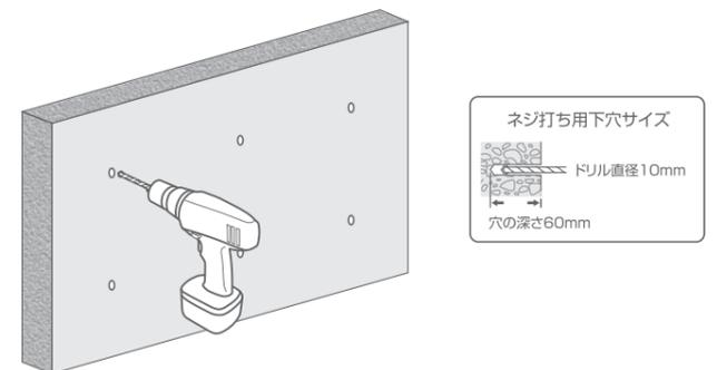
3 下穴に樹脂アンカーを挿入し、下穴と壁掛け金具の穴の位置を合わせて、壁掛け金具の穴とワッシャーにST6.3×55ネジを通して、10mm六角スパンカプラスドライバーでしっかりと固定してください。
