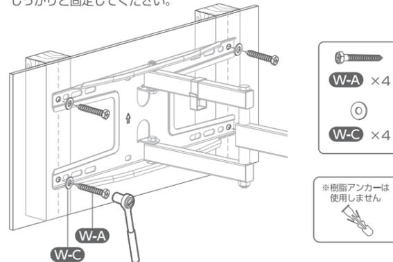
コンクリート壁の場合 取り付け可能な壁の厚み：150mm以上
