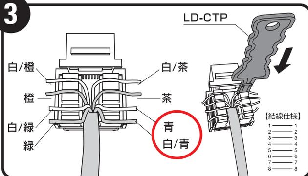
モジュラジャックに表示されている色の通りにケーブルをセットしてください。(専用工具LD-CTPを使用するとより簡単にセットできます。)
