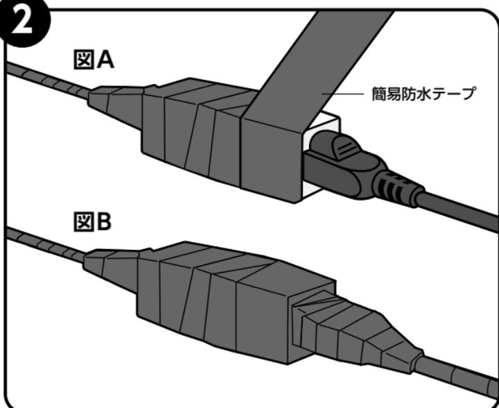
図Aのように、簡易防水テープを巻きつけます。簡易防水テープは約5倍まで伸びますので、少しずつ重なるように巻きつけてください。
