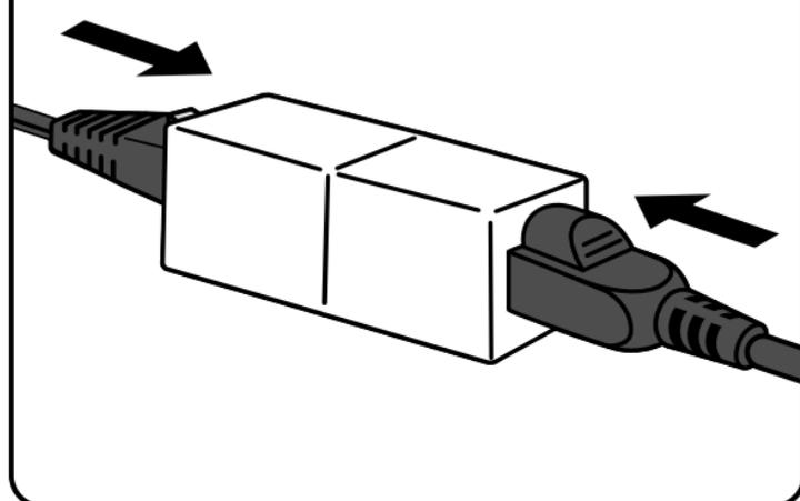
RJ45中継コネクタの両端に、ケーブルを奥までしっかりと挿し込みます。
