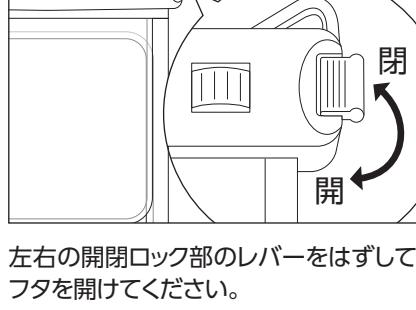
左右の開閉ロック部のレバーをはずして、フタを開けてください。
