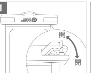
左右の開閉ロック部のレバーをはずして、フタを開けてください。
