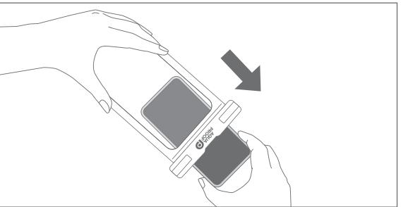
※ご使用後は本製品の水気を拭き取り、本製品の開閉ロック部を下に向けて取り出してください。(水滴や塩分などが機器本体に付着すると故障の原因になります。)
