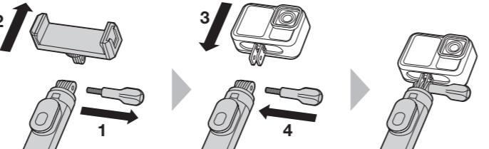
横のネジを緩めてホルダー部分を外し、GoProのツメを立てて三脚に差し込んだら、再び横のネジを差し込んで固定してください。
