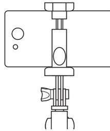
自撮り棒本体のネジを緩め、スマートフォンの背面側が前面にくるように角度を調節し、ネジを締めます。
