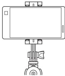
自撮り棒本体のネジを緩め、スマートフォンの画面側が前面にくるように角度を調節し、ネジを締めます。
