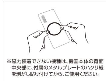
※磁力装着できない機種は、機器本体の背面中央部に、付属のメタルプレートのハクリ紙を剥がし貼り付けてから、ご使用ください。
