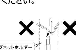
※磁力装着できない機種は、機器本体の背面中央部に、付属のメタルプレートのハクリ紙を剥がし貼り付けてから、ご使用ください。
