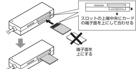
スロットの上端中央にカードの端子面を上にして合わせる
