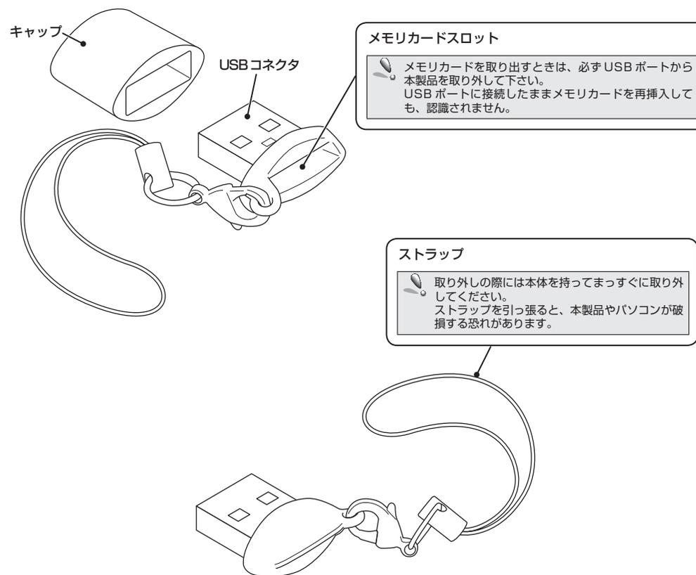
メモリーカードを取り出すときは、必ず USB ポートから本製品を取り外して下さい。USB ポートに接続したままメモリーカードを再挿入しても、認識されません。
