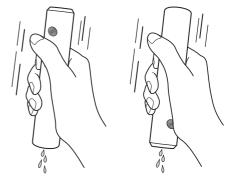
请将本体底部注水口与喷嘴安装口都沥干 水分。
