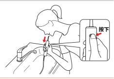
如果在连续使用过程中,约2分钟内没 有任何操作,设备会自动停止工作。自动 停止后, 您可以再次按下电源键继续使 用。但请注意,单次连续使用时间最长不 要超过4分钟。此外,建议每次连续使用后, 间隔至少30分钟再启动使用。
