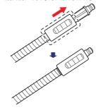
· 如果供水软管两端的部件出现脱落的情况,将软管用力按入末端部件即可重新 安装。
