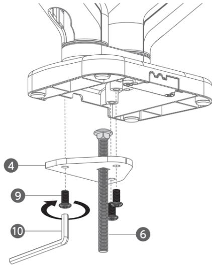
3 アームを天井に差し込み、グロメット用下プレートと蝶ネジを通します。蝶ネジをしっかりと締め付けます。
