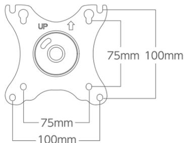
1 モニター背面側のVESAマウント用穴の上部2か所にネジ、ワッシャーを通し、プラスドライバーで半分ほど締めてアームのVESAマウントにひっかけてください。
