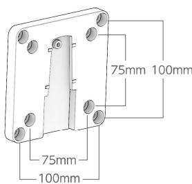
1 VESAマウントの穴とモニターの穴を合わせて、ワッシャー、ネジを通して、プラスドライバーでしっかりと締め込んでください。
