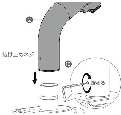
2 VESAマウント取り付けパーツをアームの先端に差し込みねじで締めて固定します。
