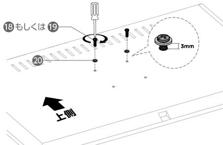
2 アーム側のVESAマウントにネジを引っ掛けた後、ネジを締めてください。残りの2つのネジも締めます。
