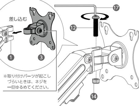
3 アームをポールに差し込み、抜け止めねじをマイナスレンチで締めます。
