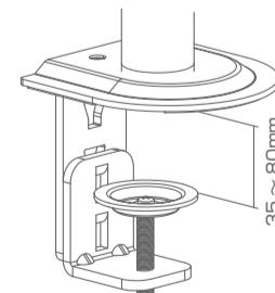
3 六角レンチでクランプのネジをしめて天板に固定します。
