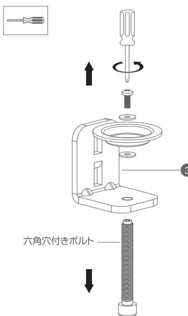
2 グロメット用プレート、天板、台座、ポール順に六角穴付きボルトを通し、六角レンチで矢印方向に回して締め付けます。
