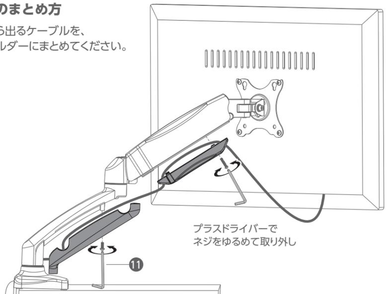
プラスドライバーでネジをゆるめて取り外し
