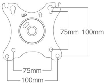
1 モニター背面側のVESAマウント用穴の上部2か所にネジ、ワッシャーを通し、プラスドライバーで半分ほど締めてアームのVESAマウントにひっかけてください。
