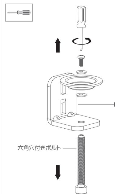
2 グロメット用プレート、天板、台座、ポールの順に六角穴付きボルトを通し、六角レンチで矢印方向に回して締め付けます。
