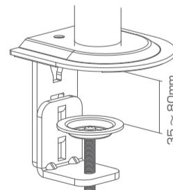
3 六角レンチでクランプのネジをしめて天板に固定します。
