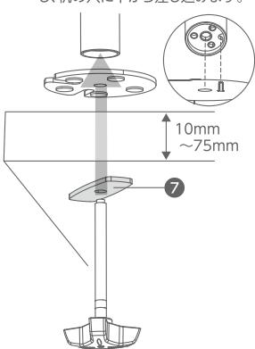
4 クッションパッドを貼った面が下にくるようにグロメット用上プレート、ポールを差し込み矢印方向に回して締め付けます。
