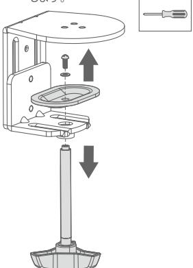
2 グロメット用上プレートの突起を上にした状態で、裏面にクッションパッドを貼り付けます。
