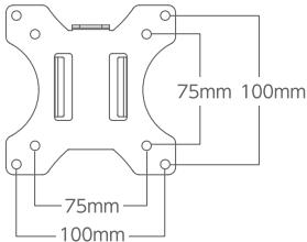
1 VESAマウントの穴とディスプレイの穴を合わせて、ワッシャー、ネジを通して、プラスドライバーでしっかりと締め込んでください。
