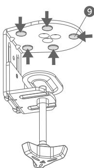
2 皿ネジでクランプとポールを固定します。
