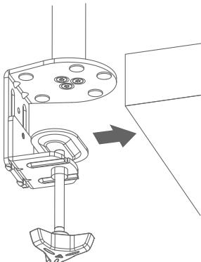
4 ハンドルを矢印方向に回して締め付けます。
