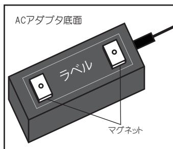
同期・充電保管庫に取付ける場合、ACアダプタに同梱のマグネットを図のように貼り付けます。
