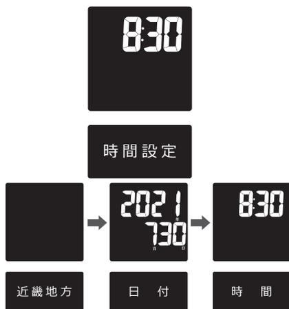
※各設定画面で無操作状態で約 30 秒経過すると、自動的に電源 OFF になります。設定途中で電源 OFF になった場合は、最初から操作をしないしてください。
