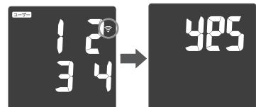
接続が完了すると、体組成計の表示部の無線通信表示 が点滅から点灯に変わります。
