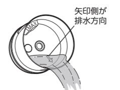
② 水タンクの底の排水方向を示す矢印の方向から排水を行ってください。
