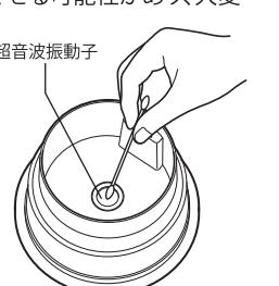
洗剤は、必ず台所用中性洗剤をご使用ください。塩素系・酸性・酵素系の洗剤は内部に残留した場合、有毒ガスなどを発生させる可能性があり、大変危険です。
