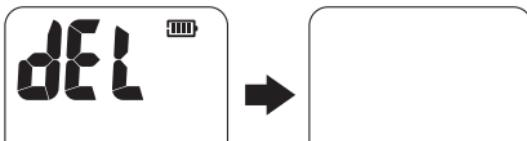
※操作中に[測定/停止]ボタンを押すか、無操作状態で約60秒経過するとスタンバイ状態になります。操作中にスタンバイ状態になった場合は、最初から操作をしなおしてください。
