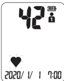
脈拍を検知すると脈波検知マークが点滅します。
