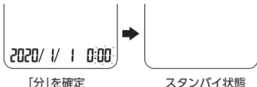
※日時設定中は時計は停止しています。「分」を確定した時点で時計のカウントを開始します。
