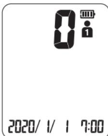
選択されているユーザー番号、時刻、電池残量マークが表示され、加圧を開始します。
