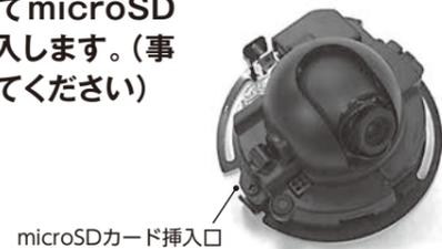
事前にmicroSDカードを挿入してからカメラを取り付けてください。(P4 microSDカードの取り付け方法参照)
