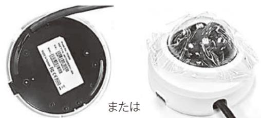
**4** 付属の専用ネジでカメラを壁または天井に仮止めし、ご希望の方向にカメラを回したのち固定します。
