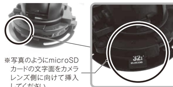
※写真のようにmicroSDカードの文字面をカメラレンズ側に向けて挿入してください。
