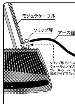
**注意点** 本製品は、各ケーブルの種類、長さ、モデムの置き場所によって大きく効果が変わります。対象物に対して包み込んだ後に、本製品から「アース」を取る必要となる場合があります。また、「ノイズウォール」と併用して使用される際には本製品と「ノイズウォール」をクリップ等で接触させ、そこから「アース」を繋いで下さい。「アース有り」と「アース無し」2通りを試して下さい。
