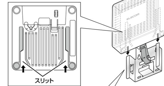
本体下部の溝と壁 / 天井設置用金具のレールの位置を合わせて差し込んでください。
