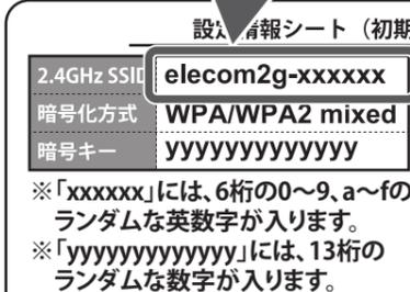
5 パスワードの入力画面が表示されるので、上記の暗号キー(13桁)を入力して[OK]をクリックします。
