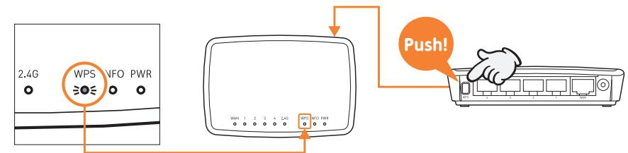
**5** 接続が確立すると、2.4GHz WLAN ランプが点灯します。
