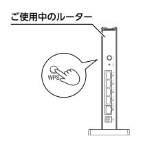
無線情報の引っ越しが完了すると、すべてのランプが 約10秒間点灯した後、WPSランプが消灯します。
